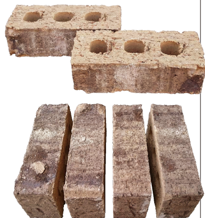
St.オーガスティンはオンドル用レンガと同じく穴のあいた中空耐火レンガ
