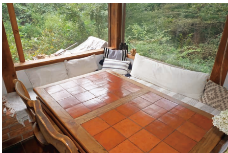
蓄熱ユニットとなるL字のヒートベンチ。煙道は水平に並ぶのではなく、上下に配されている
