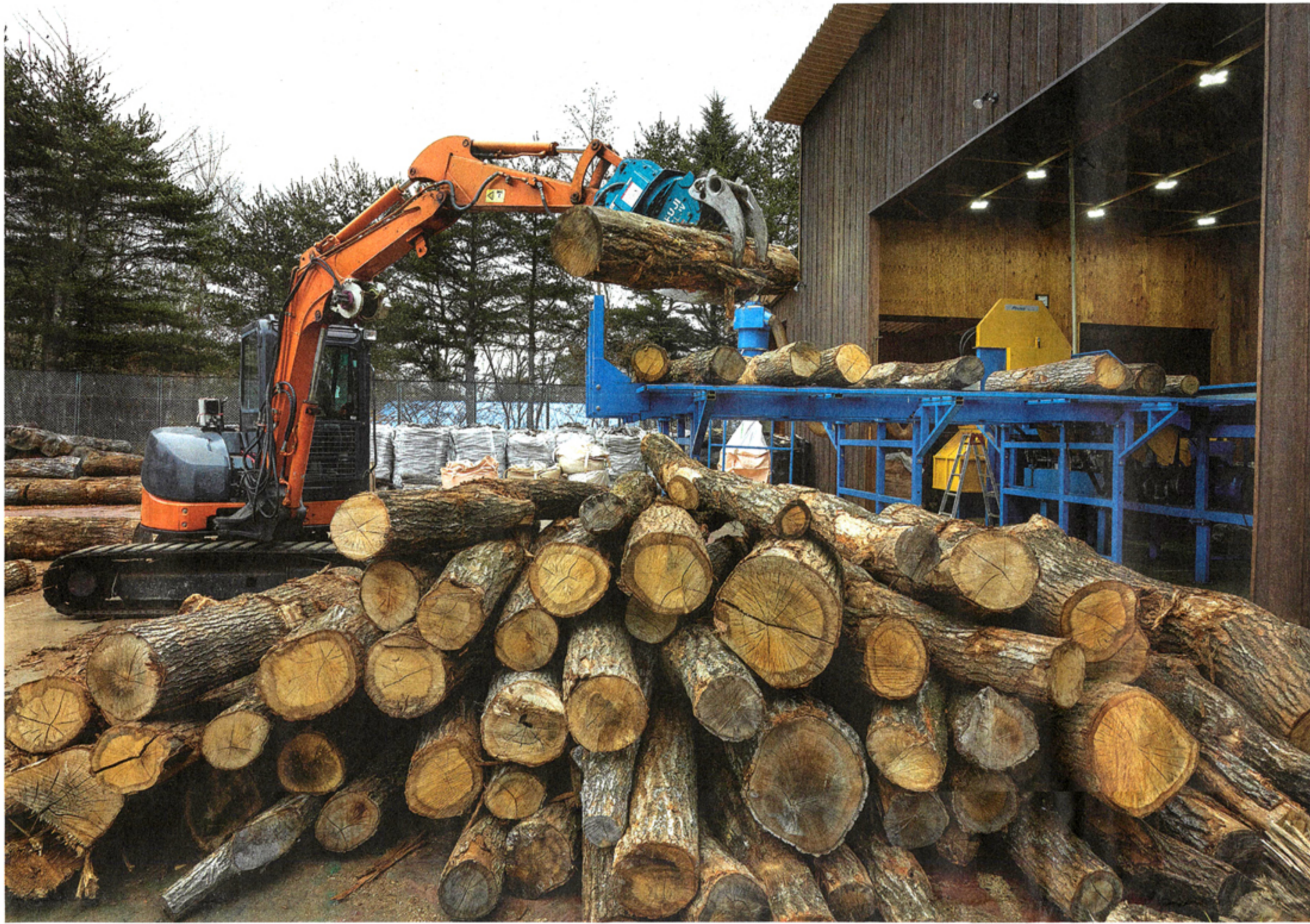
きたもっくの薪の製造拠点。近隣から集めた原木をセットすると(写真上)薪製造機が次々に薪を割っていく(同右上)。日量30トン以上を製造できるといふ(群馬県長野原町)
