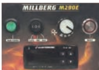
バーナーのコントロールパネル
